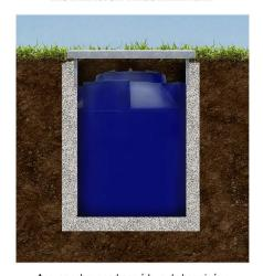
Apoyar sobre una base ó loza de hormigón y rellenar los laterales con 10cm. de hormigón.
